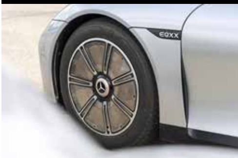
Die Form des Vision EQXX gilt als aerodynamisches Meisterwerk. In der Kabine dominiert ein riesiger Screen, die seitlichen Ein- und Auslässe erzeugen Luftvorhänge um die Räder
