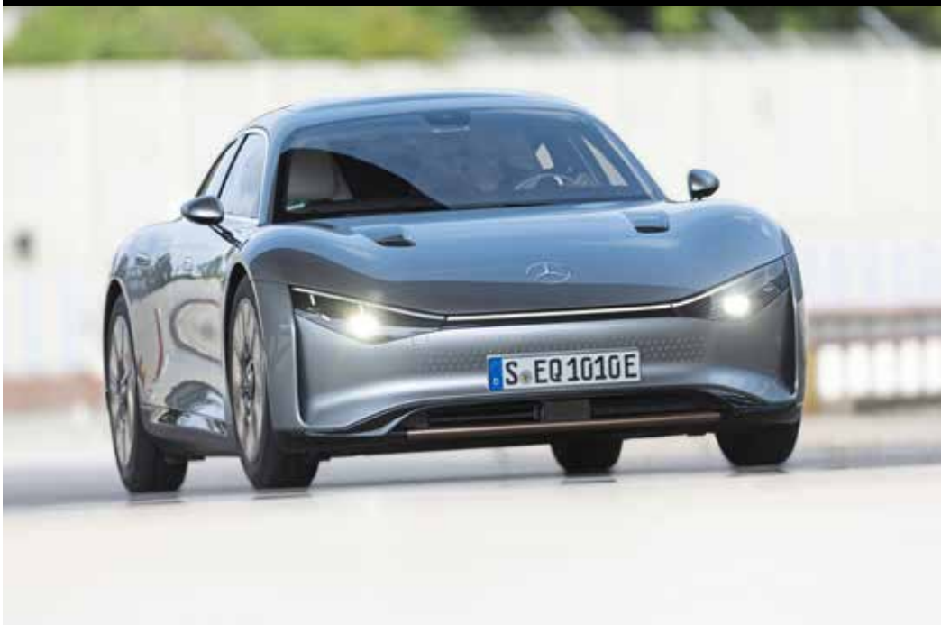
Die Form des Vision EQXX gilt als aerodynamisches Meisterwerk. In der Kabine dominiert ein riesiger Screen, die seitlichen Ein- und Auslässe erzeugen Luftvorhänge um die Räder
