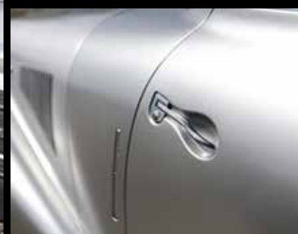
Die Form wurde im Windkanal entwickelt. Der 5,4-Liter-Reihenachtzylinder leistet 180 PS. Versenkte Türgriffe reduzieren den Luftwiderstand. Neue Inneneinrichtung mit Nussbaumholz
