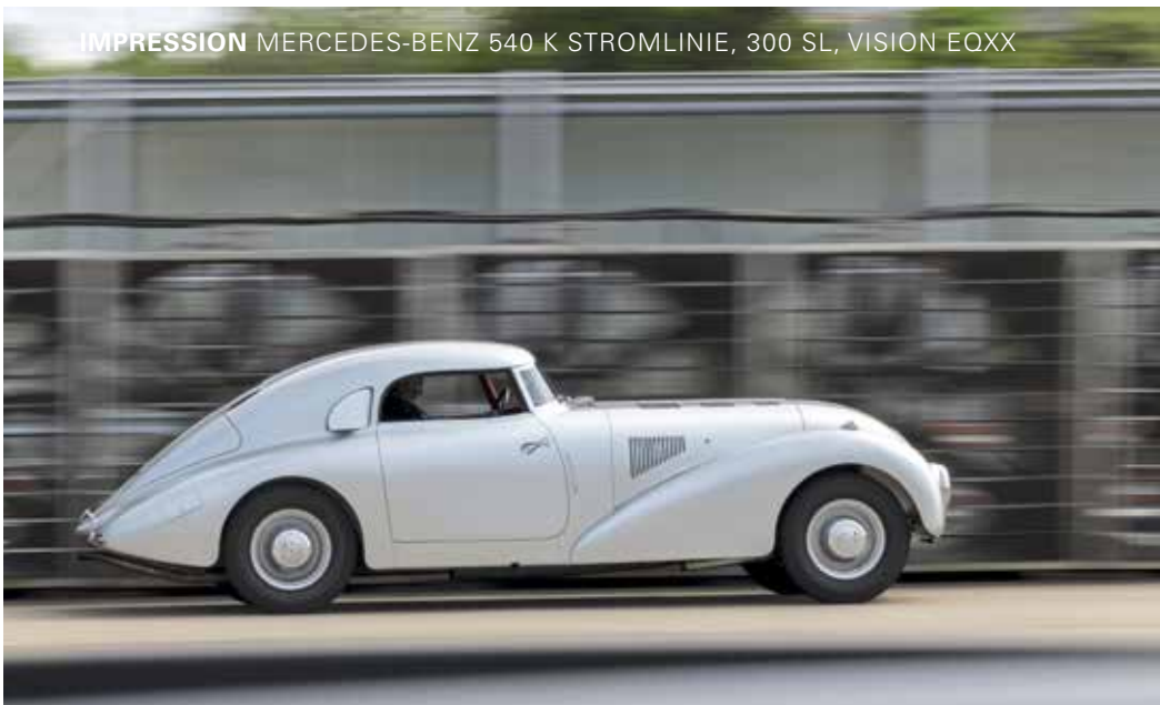
Die Form wurde im Windkanal entwickelt. Der 5,4-Liter-Reihenachtzylinder leistet 180 PS. Versenkte Türgriffe reduzieren den Luftwiderstand. Neue Inneneinrichtung mit Nussbaumholz
