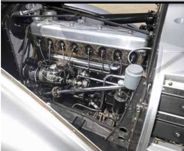
Die Form wurde im Windkanal entwickelt. Der 5,4-Liter-Reihenachtzylinder leistet 180 PS. Versenkte Türgriffe reduzieren den Luftwiderstand. Neue Inneneinrichtung mit Nussbaumholz
